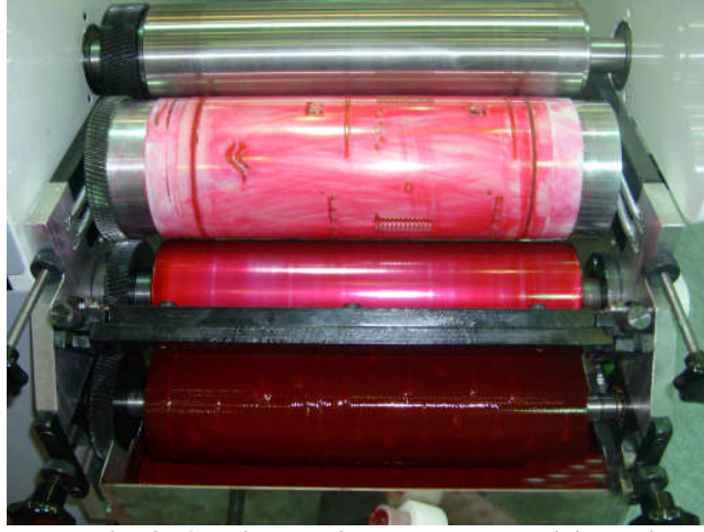
Resim 2. 6: Klişe üzerinde mürekkep birikmesi
