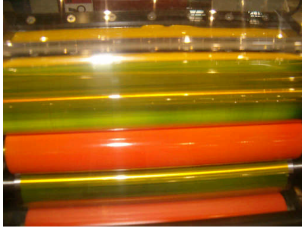
Resim 2. 8: Klişe ve transfer merdanesinin aşırı mürekkep alması
